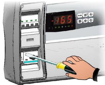
Fig. 16. Calibre el disyuntor del motor en función de la absorción medida. El valor de ajuste no deberá superar en ningún caso el valor determinado por el fabricante del compresor.
