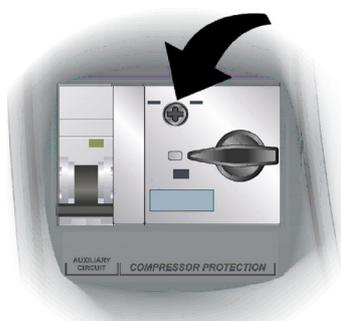
Fig. 17. Para efectuar la calibración, utilice el tornillo de ajuste situado en la parte frontal del interruptor de protección del motor.
