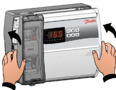
Fig. 18. Cierre el panel frontal prestando atención a que todos los cables estén dentro de la carcasa y a que la junta de esta esté correctamente colocada.
