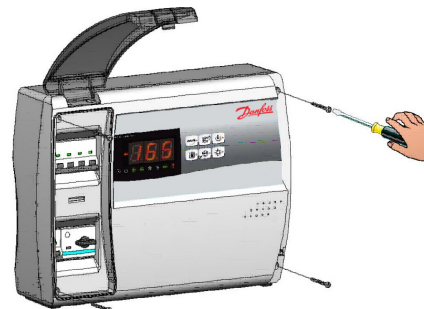
Fig 19. Serrer le panneau avant à l'aide des 4 vis. Réinstaller le cache des vis sur le côté droit.
