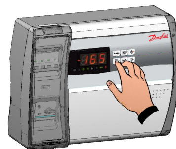
Rys 20. Włączyć zasilanie panelu i dokonać dokładnego odczytu/zaprogramowania wszystkich parametrów.
