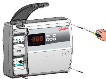
Rys 19. Dokręcić panel przedni używając do tego celu 4 śrub. Z prawej strony założyć osłonę śrub.
