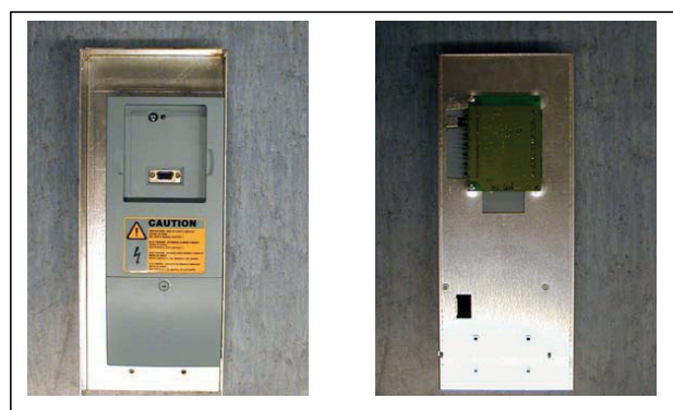
Abbildung 69. In Montagebox eingebaute Steuereinheit; links: vorn; Rechts: Rückseite
