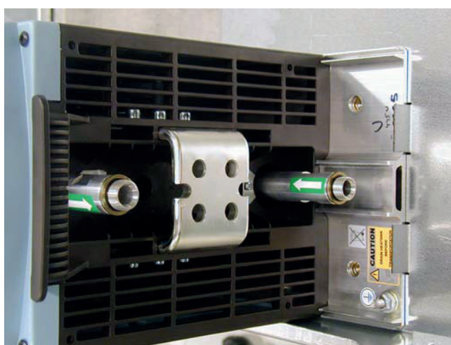
Figure 25. Adaptateurs en aluminium pour flexibles
