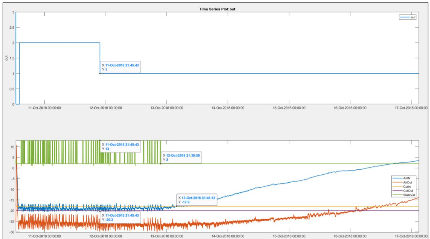
В то же время необходимость оттайки трудно оценить, отслеживая только значения температуры. Однако, по переменной состояния контроллера можно увидеть, что продолжительность рабочего цикла термостата значительно увеличивается с того момента, когда в случае работы адаптивного алгоритма уже запуталась бы оттайка. Это означает, что холодопроизводительность испарителя снизилась.
