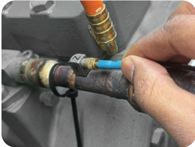
↑ La Figura 4 muestra el punto de medición de la vibración de descarga del compresor LT1 (véase el Gráfico 1).
