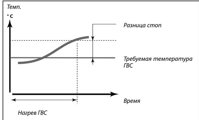
Один датчик температуры в баке-аккумуляторе ГВС (пример с отрицательным значением "Разницы стоп"):
