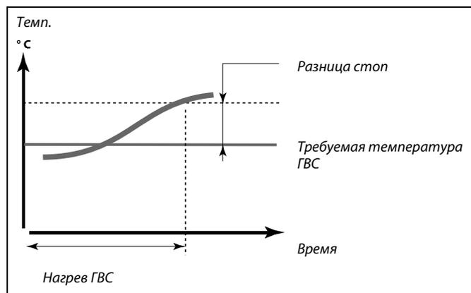
**Один датчик температуры в баке-аккумуляторе ГВС (пример с отрицательным значением "Разницы стоп"):**
