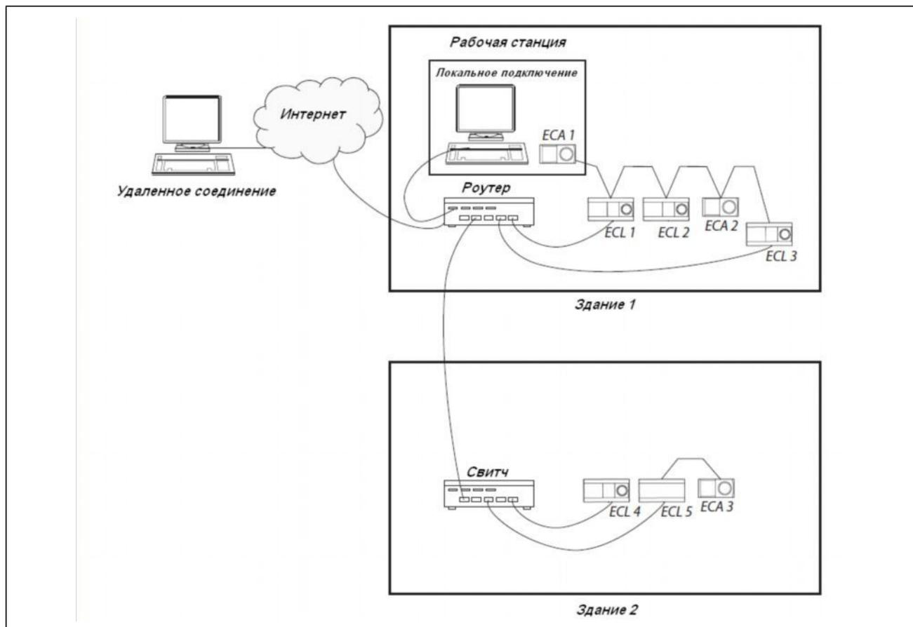
Рис. 5-1: Пример построения сети с использованием шины ECL 485, где некоторые контроллеры подключены к Интернету.
