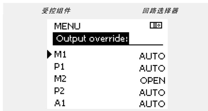
当选择的受控组件（输出）不是“自动”，ECL 舒适控制器可能不会控制相应的组件（水泵、电动控制阀等）。防冻保护也未启动。
