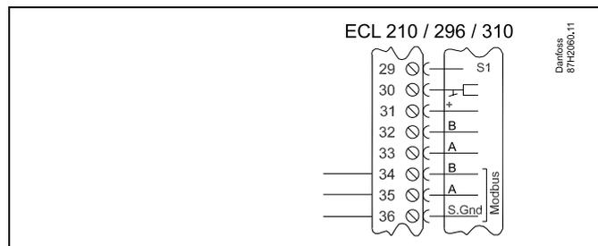
电气连接, M 总线
