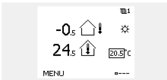
此总览界面的显示内容有：室外温度、实际室内温度以及所需室内温度。
