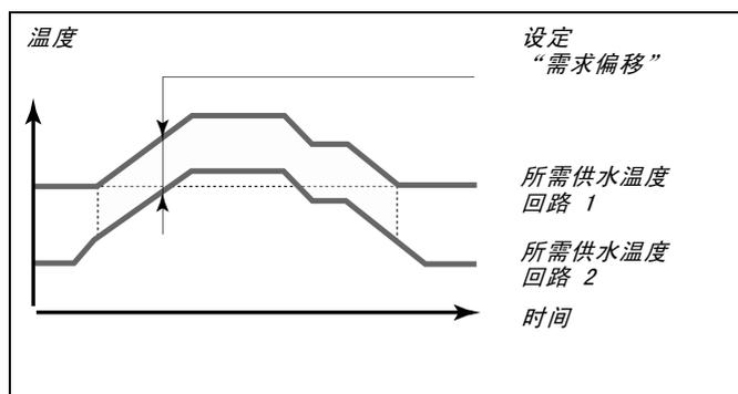
‘需求偏差’功能可以补偿主控制系统和从控制系统之间的热量损失。
