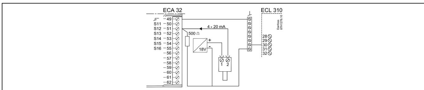
通过 500 ohm 电阻器的电流为 4 - 20 mA 时, 电压为 2-10 volt
