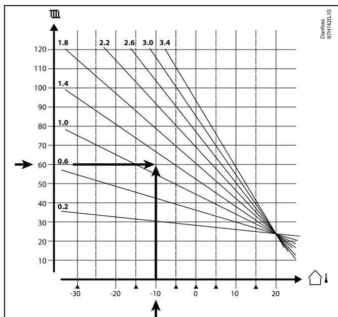
根据所在地区的设计最低室外温度（横轴），选择供暖系统的所需供水温度（竖轴）。选择这两个值的公共点距离最近的供热曲线。
