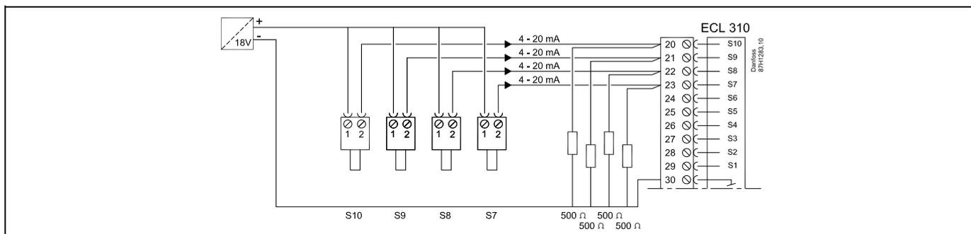
通过 500 ohm 电阻器的电流为 4 - 20 mA 时, 电压为 2-10 volt。
