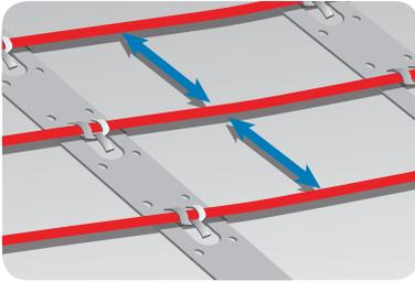
$$\text{Шаг укладки [см]} = \frac{\text{Удельная мощность кабеля [Вт/м]}}{\text{Плотность теплового потока [Вт/м}^2\text{]}} \times 100 \text{ см}$$
