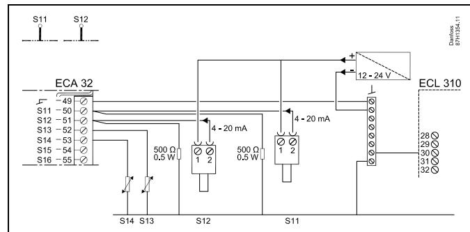
Eksemplet viser forsyning til ECL 310, 24 V a. c.
