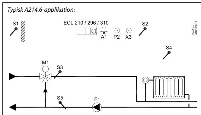
Det viste diagram er et grundlæggende og forenklet eksempel og indeholder ikke alle komponenter, der er nødvendige i et system.
