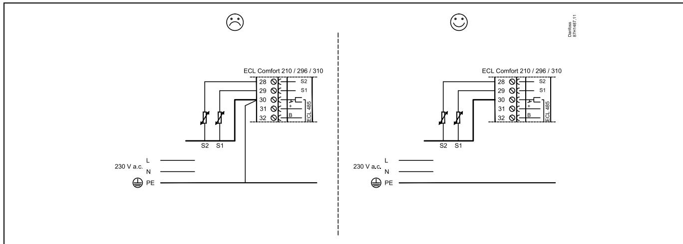
Eksempel på overstyringskontakt, tilsluttet til S8:
