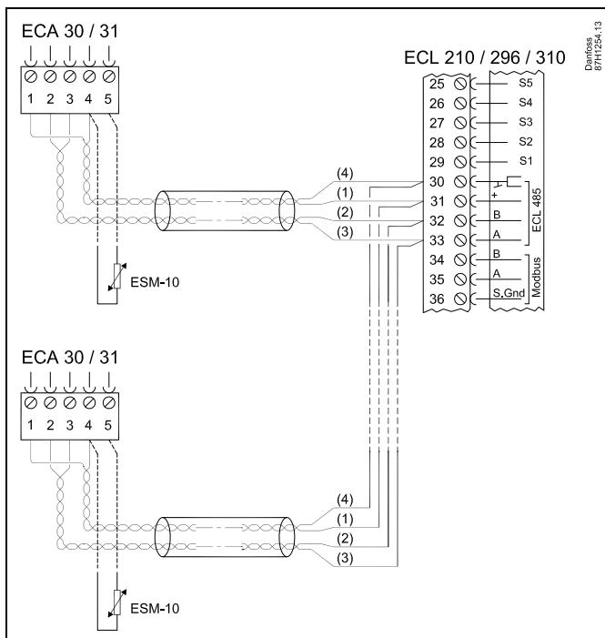
Maks. 2 ECA 30/31 kan tilsluttes til en ECL Comfort 310 regulator eller til ECL Comfort 210 / 296 / 310 regulatorer i et master/slave system.
