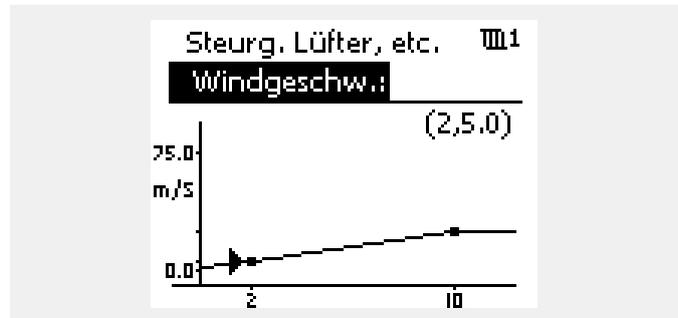
Beispiel: Verhältnis zwischen Eingangsspannung und angezeigter Windgeschwindigkeit
