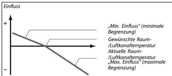
Durch den „Max. Einfluss“ und den „Min. Einfluss“ wird festgelegt, in welchem Umfang die Raum-/Luftkanaltemperatur Einfluss auf die gewünschte Vorlauf-/Luftkanaltemperatur nehmen soll.
