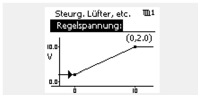
Beispiel: Verhältnis zwischen angezeigter Windgeschwindigkeit und Regelspannung
