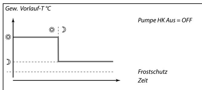
Die min. Begrenzung der Vorlauftemperatur („Min. Temperatur“) wird aufgehoben, wenn „Pumpe HK Aus“ eingeschaltet ist.
