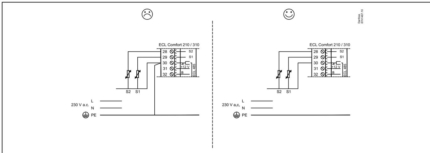
Beispiel eines Übersteuerungskontakts, angeschlossen an S8:
