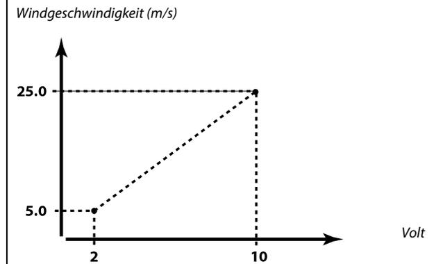
Diesem Beispiel ist zu entnehmen, dass 2 Volt einer Windgeschwindigkeit von 5.0 m/s entsprechen und 10 Volt einer Windgeschwindigkeit von 25.0 m/s.
