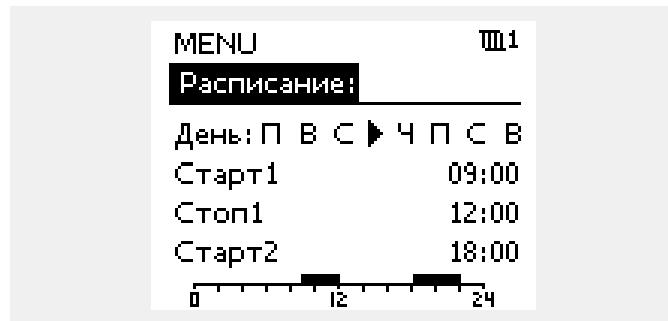
График показывает время начала и окончания комфорного периода (контур отопления и контур ГВС) для каждого дня недели.
