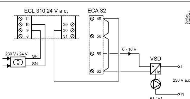
VSD = привод с регулируемой скоростью
