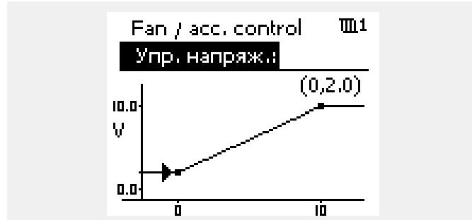
Пример: Связь между отображаемой скоростью ветра и управляющим напряжением
