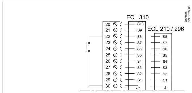
**Пример: Подключение реле блокировки автоматического управления**
