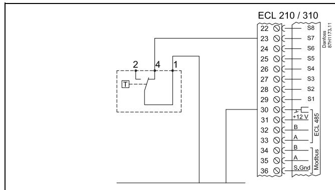
**Контроль соединений вентилятора и фильтра (S9 и S10):**
