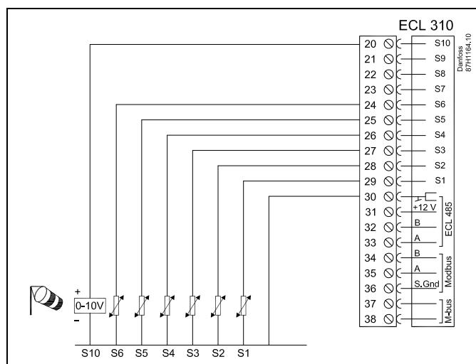
\* Если датчик температуры наружного воздуха не подключен или в кабеле произошло короткое замыкание, регулятор считает температуру наружного воздуха равной 0 (нулю) °C.
