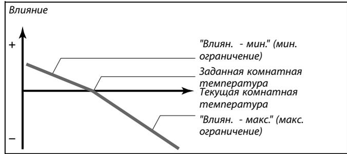
"Влиян. - макс." и "Влиян. - мин." определяют влияние температуры воздуха в помещении на температуру подаваемого теплоносителя/воздуховода.
