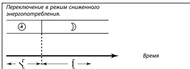
Результат переключения в режим сниженного энергопотребления зависит от настройки параметра «Полный останов».
