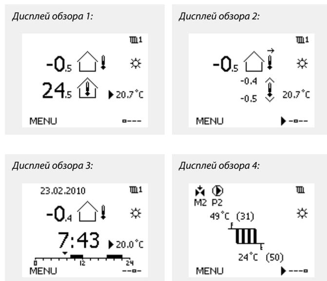
В зависимости от выбранного дисплея, на обзоре контура отопления может отображаться следующая информация:
