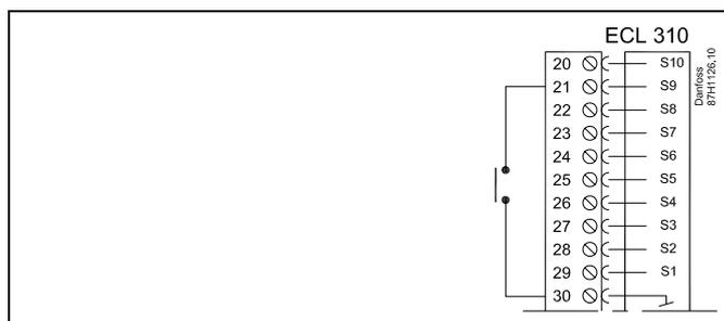
Для подключения внешнего переключателя выбирайте только неиспользованные входы. Если для подключения внешнего переключателя будет назначен уже используемый вход, работа данного входа будет также прервана.
