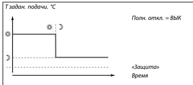
Минимальное ограничение температуры подачи («Т мин.») отменяется, когда параметр «Полное отключение» имеет значение ВКЛ.
