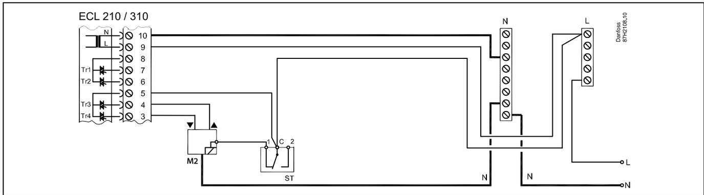
**С термостатом безопасности, двухступенчатое закрытие:**
