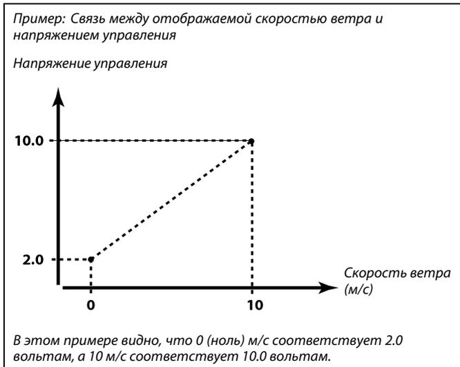
"Напряжение управления" доступно только из внутреннего модуля ECA 32.
