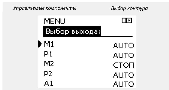
Когда выбранный управляемый компонент (выход) не в автоматическом режиме, регулятор ECL Comfort не управляет им (насос или регулирующий клапан с электроприводом и т.п.). Защита от разморозки не работает.
