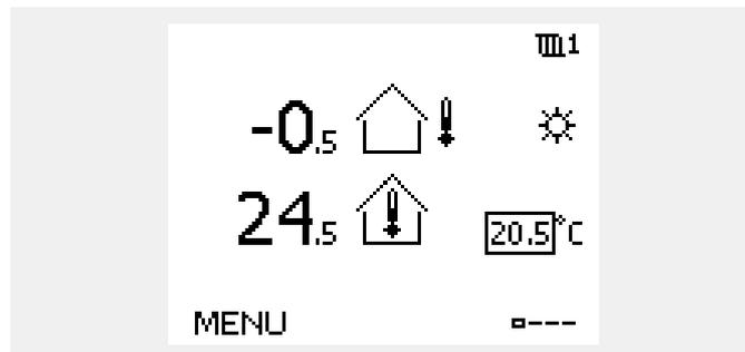
Das rechts aufgeführte Übersichtsdisplay informiert über die Außentemperatur, die aktuelle Raumtemperatur und die gewünschte Raumtemperatur.
