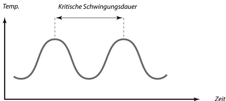
Die kritische Schwingungsdauer ist ein charakteristischer Wert für die Anlage. Sie können die Einstellungen für die Regelparameter mit Hilfe der kritischen Schwingungsdauer vornehmen:
