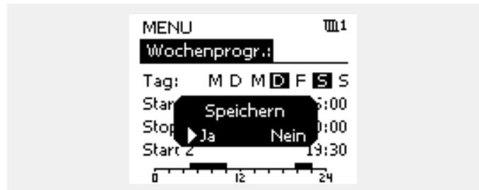
Jeder Heizkreis hat sein eigenes Zeitprogramm. Um zum anderen Heizkreis zu wechseln, gehen Sie zum Display Home und drehen Sie den Navigator. Wählen Sie dann den gewünschten Heizkreis.
