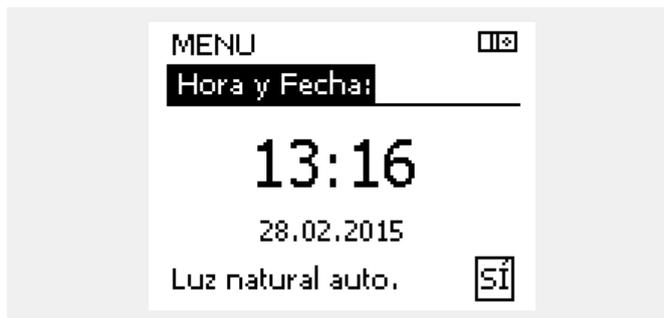
Cuando los reguladores estén conectados como esclavos en un sistema maestro / esclavo (a través del bus de comunicación ECL 485), recibirán el parámetro "Hora y Fecha" del regulador maestro.
