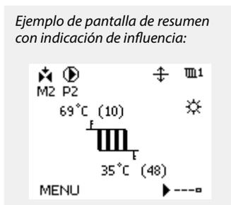
El ajuste de la temperatura ambiente deseada es importante incluso si no hay un sensor de temperatura ambiente o una unidad de control remota conectados.
