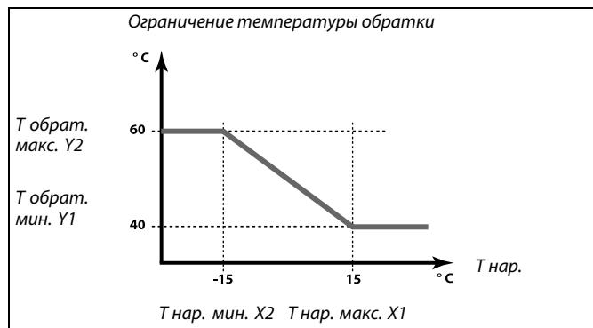
Рассчитанный предел приведен в скобках () на дисплее контроля. См. раздел «Контроль температур и компонентов системы».
