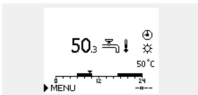
Кроме информации о требуемой и действительной температуре ГВС на данном экране отображается сегодняшняя программа работы.
