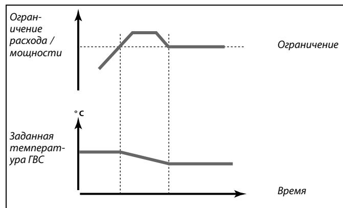
Параметр «Единицы измер.» (ID 1x115) имеет меньший диапазон настройки, когда сигнал расхода / мощности идет через M-bus.
