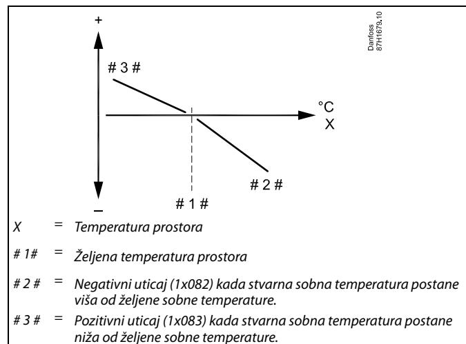
Parametri „Uticaj - max.“ i „Uticaj - min.“ određuju koliko bi sobna temperatura trebalo da utiče na željenu temperaturu dovoda.
