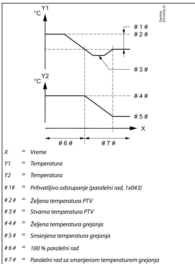
Ako stvarna temperatura PTV odstupa više od podešene vrednosti, motor sa prenosom M2 u krugu grejanja postepeno će se zatvoriti do te mere da će se temperatura PTV stabilizovati na najnižoj prihvatljivoj vrednosti.
