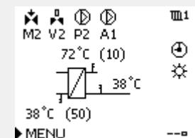
Vrednost iznad simbola V2 označava 0–100% analognog signala (0–10 V).
