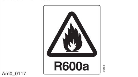
Рис. 6. Этикетка на компрессоре, работающем с хладагентом R600a
