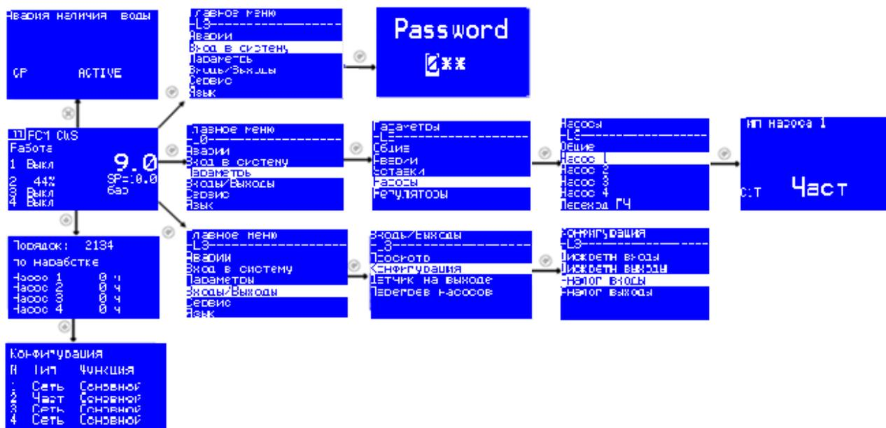
Рисунок 2. Структура расположения основных экранов
