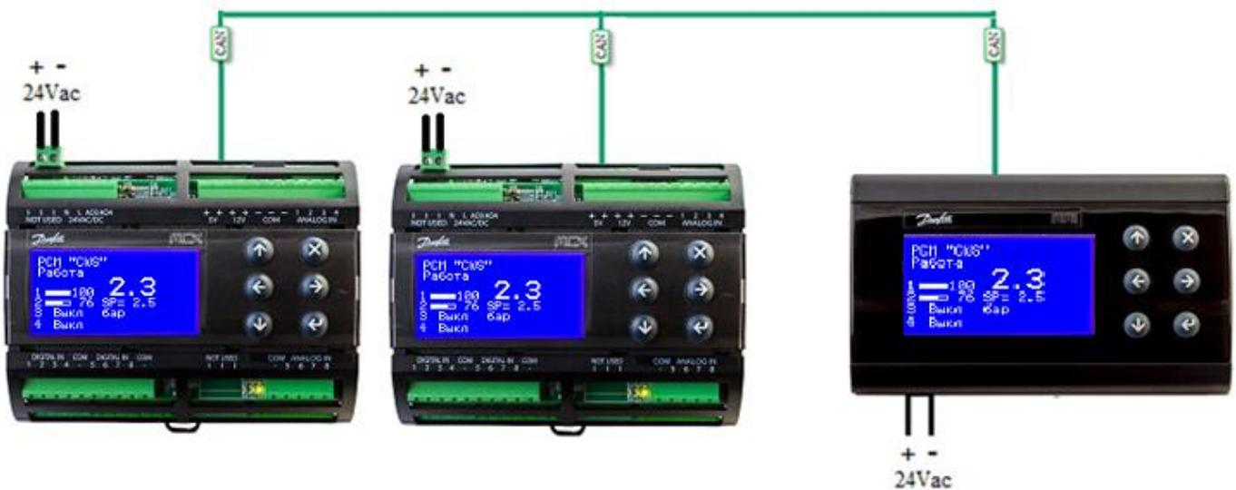
Рисунок 18. Подключение внешнего дисплея к двум модулям. В CAN-подключении среднего контроллера отсутствует переключатель между R120-CANH.
