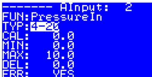
Рисунок 16. Сконфигурированный аналоговый вход контроллера на датчик давления.
