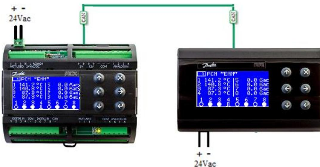
Рисунок 8. Подключение внешнего дисплея к одному модулю
