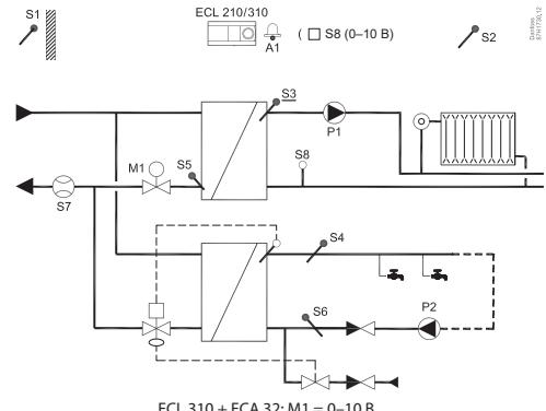
**Приложение A230.4c.** Зависимая система отопления. Опциональная функция мониторинга давления, температуры горячей и холодной воды
