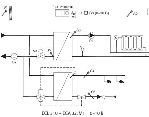
**Приложение A230.4b.** Независимая система отопления. Опциональная функция мониторинга давления, температуры горячей и холодной воды
