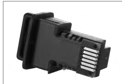
Электронный ключ программирования приложения A230 предназначен для обеспечения работы универсального регулятора температуры ECL Comfort 210 по управлению оборудованием одной системы отопления или холодоснабжения либо установкой со спаренными насосами (вариант приложения A230.2d), которые проиллюстрированы на приведенных ниже рисунках (стр. 68–69).
