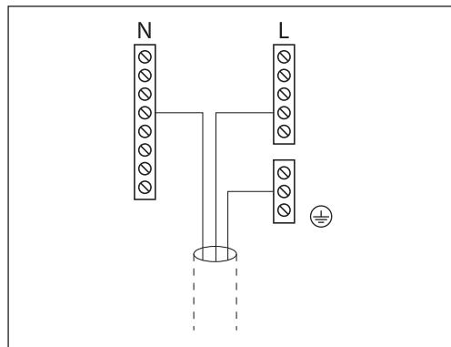
Общая клемма заземления используется для подключения соответствующих компонентов (насосы, регулирующие клапаны с электроприводом).
