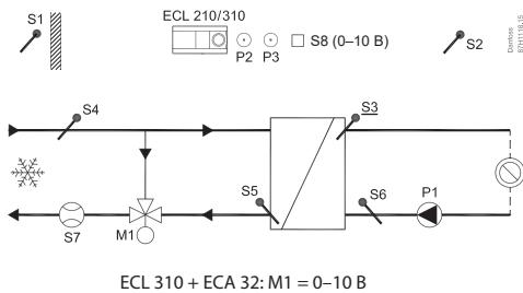
**Приложение A230.2d.** Схема управления работой установки со спаренными циркуляционными насосами
