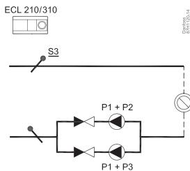
**Приложение A230.4a.** Независимая система отопления. Опциональная функция мониторинга давления, температуры горячей и холодной воды
