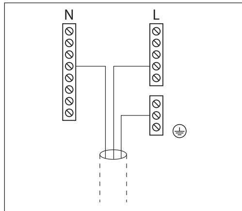
Общая клемма заземления используется для подключения соответствующих компонентов (насосы, регулирующие клапаны с электроприводом).
