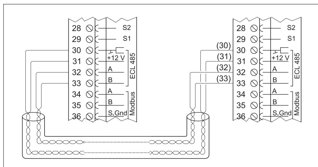
Суммарная длина всех низковольтных кабелей (от датчиков, связей с теплосчетчиком и регуляторов между собой, включая внутреннюю коммуникационную шину ECL 485) не
