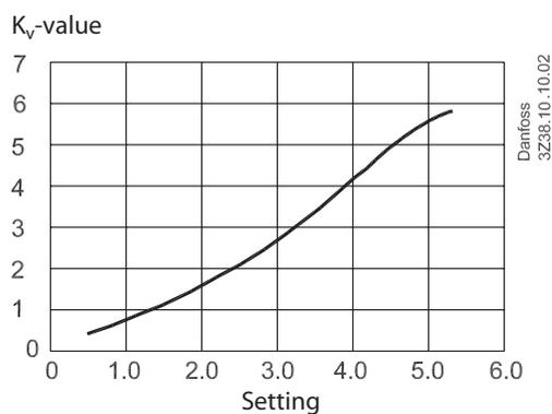
Flow Diagrammes, DN 25 LENO™ MSV-O DN 25
