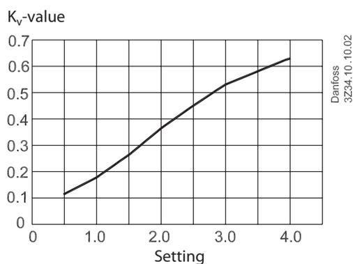
Flow Diagrammes, DN 15 LENO™ MSV-O DN 15
