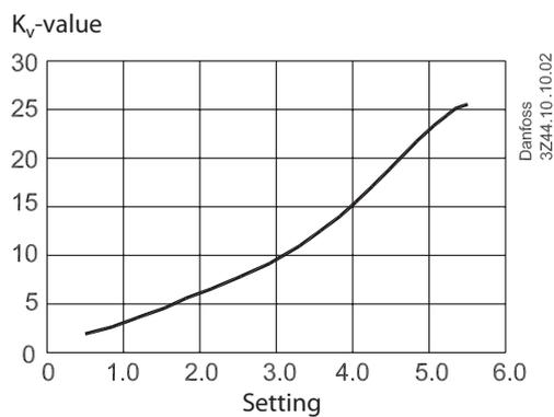
Flow Diagrammes, DN 50 LENO™ MSV-O DN 50
