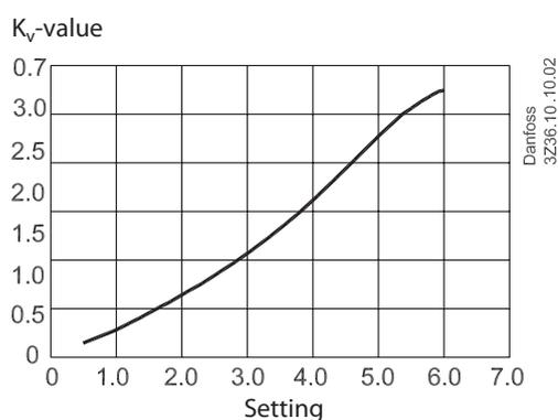
Flow Diagrammes, DN 20 LENO™ MSV-O DN 20
