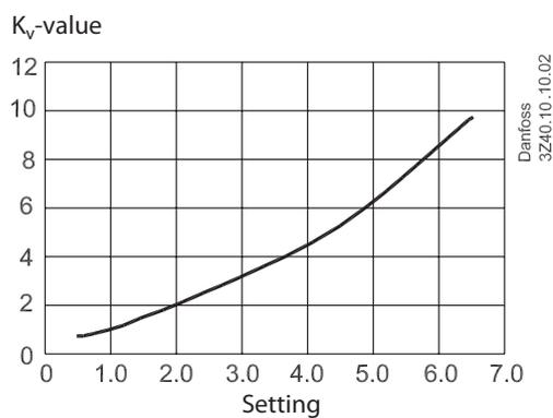
Flow Diagrammes, DN 32 LENO™ MSV-O DN 32
