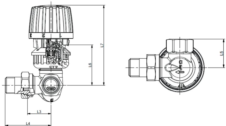
RA-DV Durchgangsventil/RA 2990 Fühler
