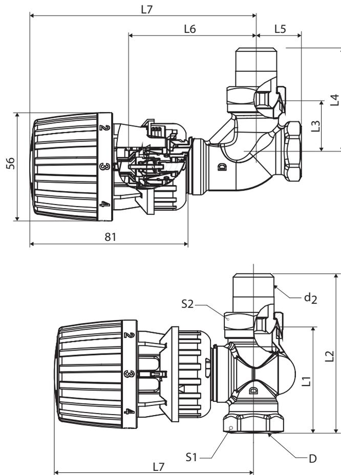
RA-DV DN 20 Durchgangs- und Eckventil/Fühler RA 2990
