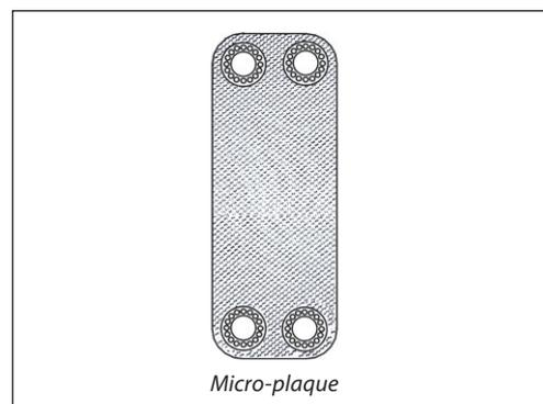
**Échangeurs à plaques brasées à une passe de type XB**
