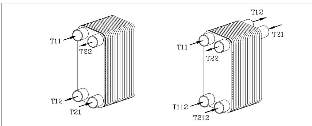
Les échangeurs de chaleur sont constitués de plaques d'échange de chaleur préformées et brasées entre lesquelles sont créés les canaux de circulation. Les fortes turbulences et le principe du contre-courant permettent un transfert de chaleur efficace. L'échangeur de chaleur transfère de la chaleur d'un flux primaire à un flux secondaire par le biais d'une plaque de transfert de chaleur, empêchant ainsi tout mélange entre les deux flux.
