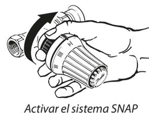
Después de desmontarla active el sistema "Snap" mediante giro del cabezal de unión para poder montarse nuevamente.
