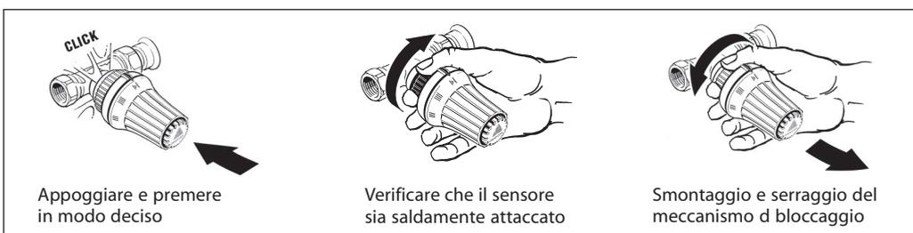
Il montaggio del sensore sul corpo valvola è molto semplice, non è necessario utilizzare alcun utensile: è sufficiente appoggiare il sensore e premere. Un anello di serraggio permette all'attacco di fissarsi automaticamente a scatto sulla valvola quando si preme. L'articolo viene fornito con il meccanismo di
