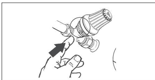
Dopo aver montato il sensore premere il clip della sicura antifurto nell'apposito alloggiamento.
