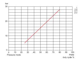
Note! Fix speed mode 2800 min<sup>-1</sup>
