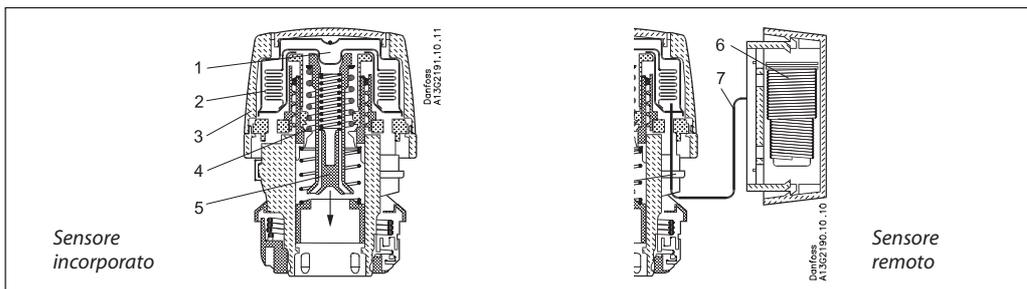
Il funzionamento dei sensori si basa su un elemento sensibile a soffietto a tensione di vapore che viene attivato direttamente dalla temperatura ambiente. Quando la temperatura ambiente diminuisce, il soffietto all'interno dell'elemento termostatico si
