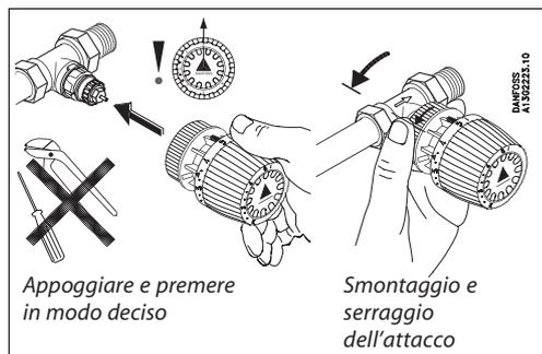
Il montaggio del sensore sul corpo valvola è molto semplice, non è necessario utilizzare alcun utensile: è sufficiente appoggiare il sensore e premere in modo deciso.
