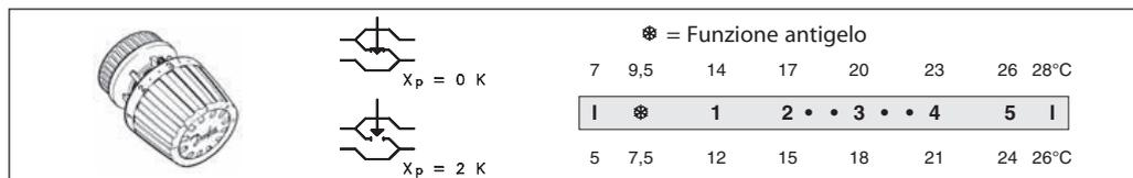
La regolazione della temperatura ambiente che, con  $X_p = 2 \text{ K}$ , corrisponde alle cifre indicate sul sensore, si basa sulla scala sopraindicata. Questi valori sono solo dei valori di riferimento poiché la temperatura reale varia anche in base alle caratteristiche dell'installazione.
