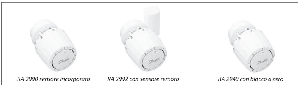
I sensori RA 2000 sono dei regolatori proporzionali automatici a riempimento di gas con un'alzata specifica di 0,37 mm/K. Garantiscono la migliore qualità nella regolazione della temperatura e il massimo risparmio energetico e sono idonei a impianti conformi alla norma DIN V 4701/10 con una banda - proporzionale  $\leq 1K$  (EnEV: *Energieeinsparverordnung* Regolamento per il risparmio energetico).
