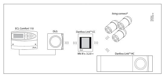
Bei der Systemintegration des Reglers ECL Comfort 110 und Danfoss Link™ über die DLG-Schnittstelle kann Folgendes erreicht werden:
