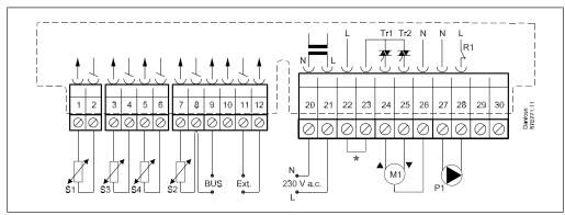
\* Anschlüsse für Sicherheitsthermostat
