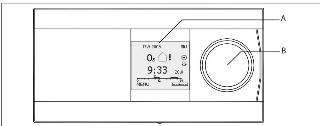
En el display monocromo (A) se muestran todos los valores de temperatura y la información de estado; además, el display se utiliza para ajustar los parámetros de control. El display dispone de luz de fondo. Asimismo, permite seleccionar distintas pantallas favoritas. En los menús, la navegación, el desplazamiento y la selección de elementos se realizan con la rueda de control o mando multifuncional (B).
