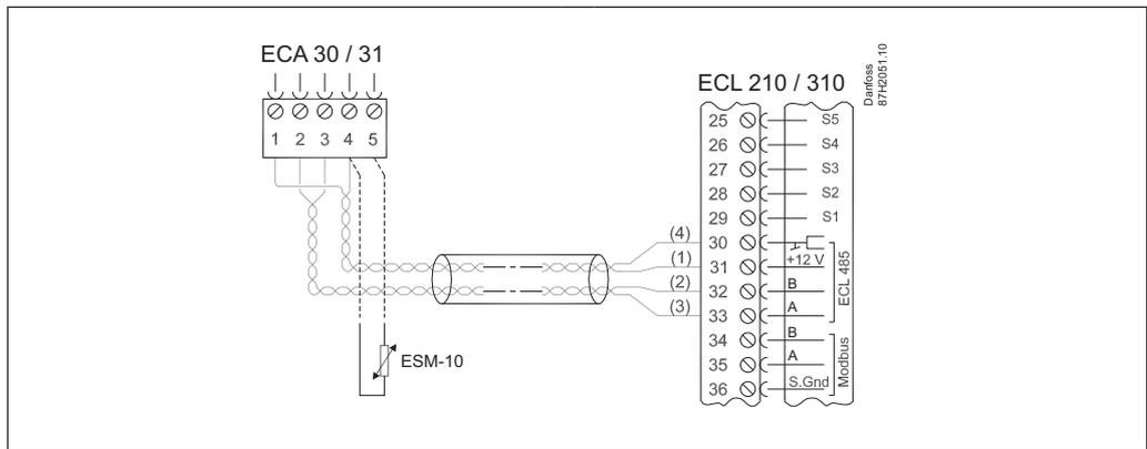
Cableado de un regulador ECL Comfort 310/310B y una unidad de control remota ECA 30/31
