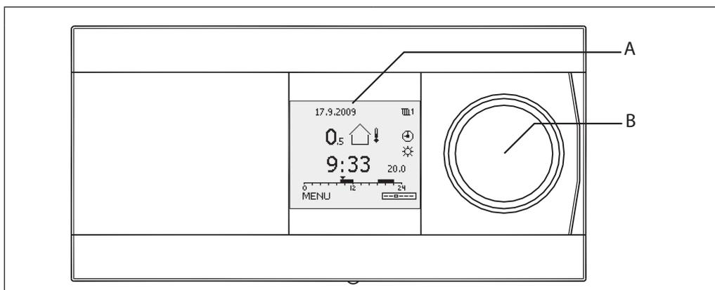
L'écran graphique monochrome (A) indique les valeurs de température, ainsi que les informations d'état, et sert au réglage des paramètres de régulation. L'écran est rétroéclairé. Plusieurs écrans favoris peuvent être sélectionnés. La navigation et la sélection des éléments dans les menus s'effectuent au moyen du bouton multifonction (B).
