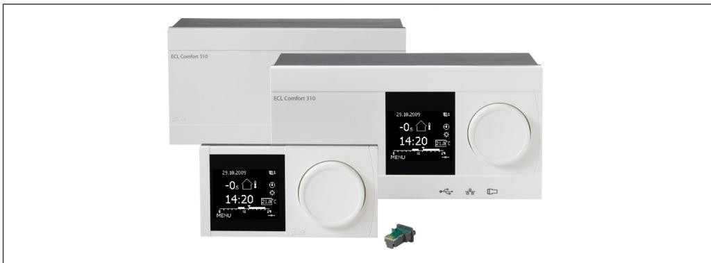
ECL Comfort 310 je elektronski kontroler za topotne podstanice u sistemima daljinskog grejanja. Radi na principu regulacije dovodne temperature sekundara zavisno od promene spoljnih uslova. Pripada porodicu regulatora ECL Comfort, a koristi se i u sistemima centralnog grejanja i rashladnim sistemima. Ušteda energije može se postići pravilnom regulacijom dovodne temperature u sistemima grejanja i rashladnim sistemima. Moguće je regulisati do 4 kruga.
