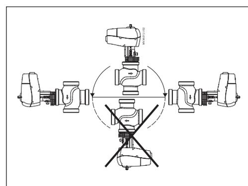
La instalación de la válvula con el actuador es posible en posición horizontal o hacia arriba. No se permite su instalación orientada hacia abajo.
