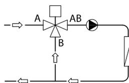
Fig. 2: valvola miscelatrice utilizzata in applicazioni di miscelazione
