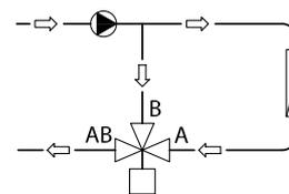
Fig. 3: valvola miscelatrice utilizzata in applicazioni di derivazione
