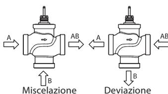
Fig. 1: utilizzo delle porte in miscelazione o deviazione
