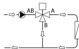
Fig. 4: valvola deviatrice utilizzata in applicazioni di deviazione
