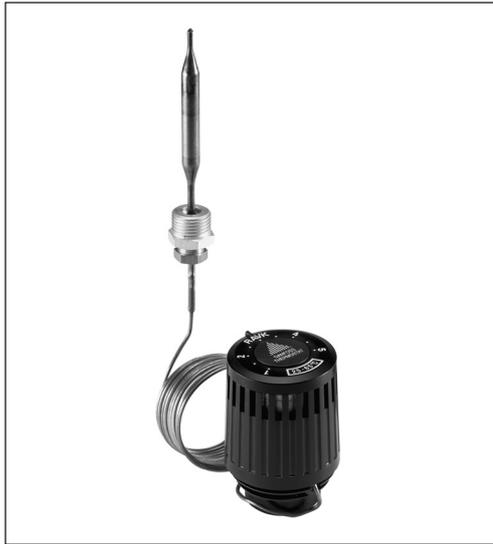
RAVK ist zusammen mit den Durchgangs- und Dreiwegeventilen ein direkt wirkender Proportionalregler ohne Fremdenergie, der bei steigender Fühlertemperatur schliesst.
