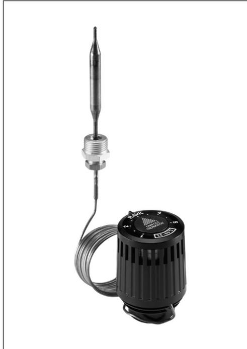
RAVK ist zusammen mit den Durchgangs- und Dreiwegeventilen ein direkt wirkender Proportionalregler ohne Fremdenergie, der bei steigender Fühlertemperatur schliesst.
