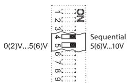
**DIP6: Prop./3-pnt - Selector de modo de funcionamiento modulante o como actuador de 3 puntos:**
