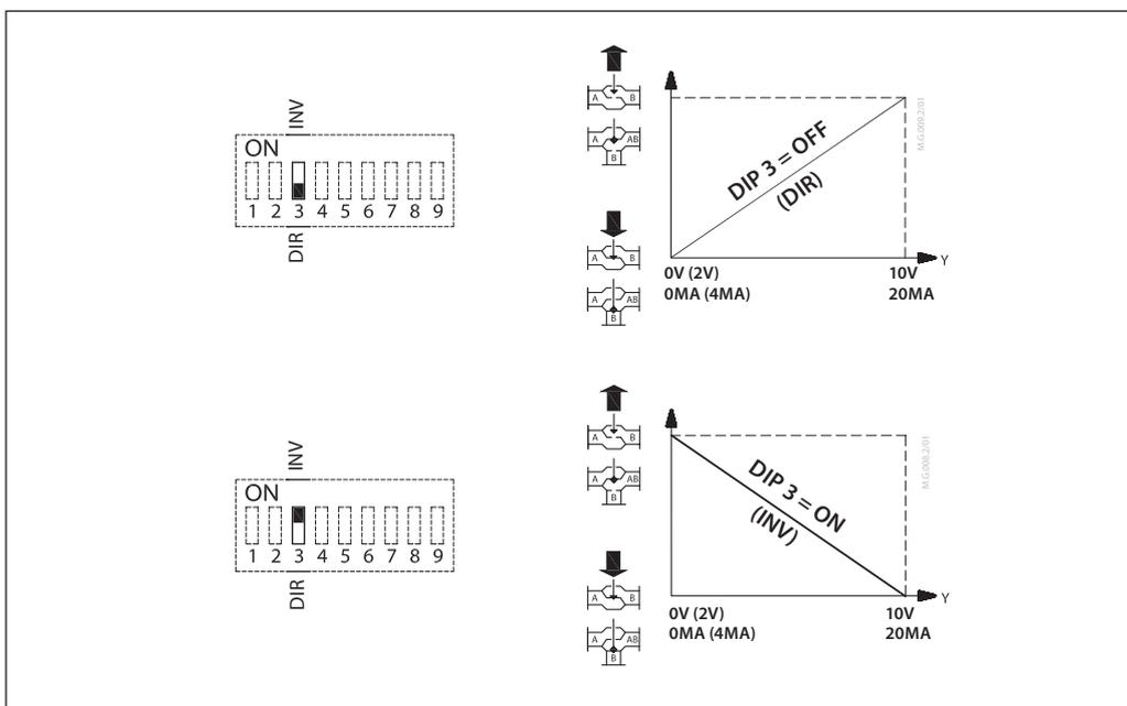
El actuador cuenta con una selección de interruptores DIP bajo la cubierta desmontable. El interruptor proporciona las siguientes funciones:
