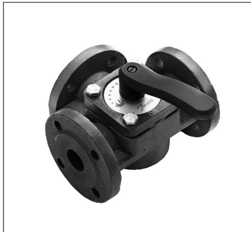
Les vannes à secteur HFE de Danfoss sont avant tout conçues pour réguler la température de départ dans des installations de chauffage dans lesquelles une certaine fuite peut être tolérée et où l'on n'exige pas une caractéristique de régulation définie.
