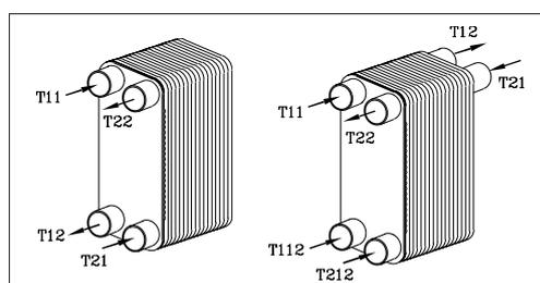
2-Kreis-Wärmeübertrager von Danfoss weisen sechs Anschlüsse auf, da sie hauptsächlich zur Erwärmung von Leitungswasser zum Einsatz kommen. Einer der zusätzlichen Anschlüsse dient der Zirkulation von Warmwasser. Der andere ermöglicht das Sammeln und Entziehen von Wärme aus dem Rücklaufwasser von der Beheizung des Wärmeübertragers. Die Anschlüsse T112 und T212 können blockiert werden, wenn sie nicht verwendet werden.
