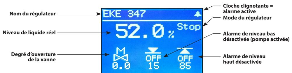
L'écran affiche l'état du **niveau de liquide**, le **mode du régulateur** (régulateur Marche/Arrêt), le **degré d'ouverture de la vanne**, l'**alarme de niveau bas** (off = aucune alarme présente) et l'**alarme de niveau haut** (off = aucune alarme présente).
