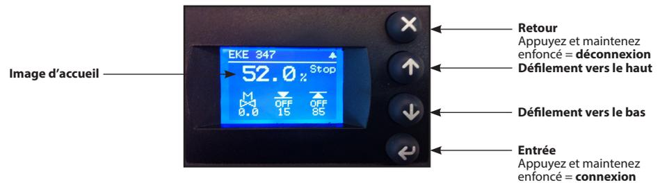
L'interface utilisateur du panneau de commande se compose d'un écran multiligne et de 4 boutons-poussoir distincts : entrée, défilement vers le haut, défilement vers le bas et retour.
