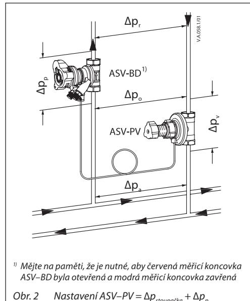
ASV-BD lze použít mimo nebo uvnitř regulovaného okruhu podle toho, která měřicí koncovka je otevřená. Změnu zapojení lze provést pod tlakem – jednoduše uzavřením/otevřením měřicích koncovek.
