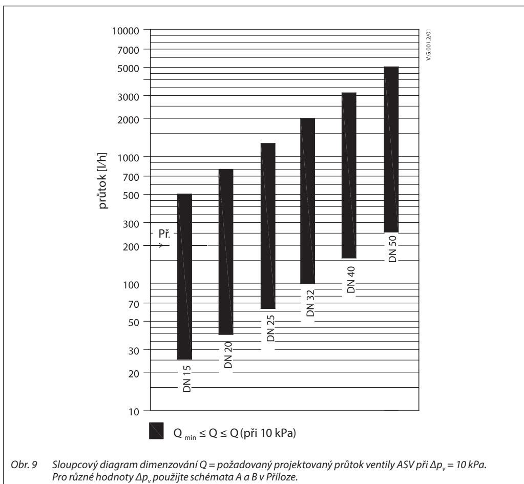
Doporučujeme dimenzovat průměr ventilů ASV-PV pomocí obr. 9. Maximální průtoky jsou založeny na diferenčním tlaku na ventilu ASV-PV 10 kPa, což umožňuje perfektní regulaci ASV-PV a šetří energii, zatímco minimální nominální průtok umožňuje regulovatelnost blížící se nule.
