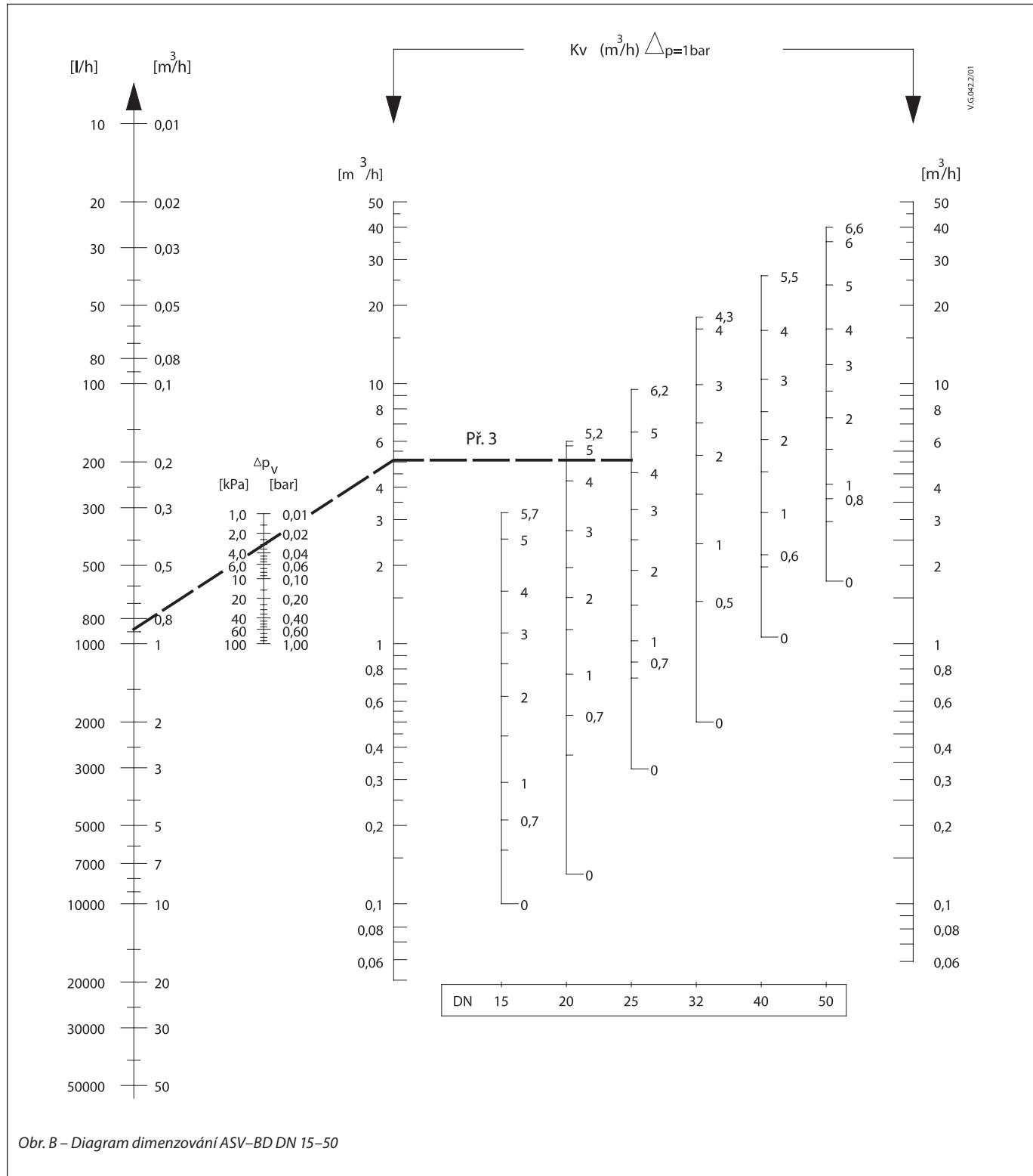
Obr. B – Diagram dimenzování ASV–BD DN 15–50
