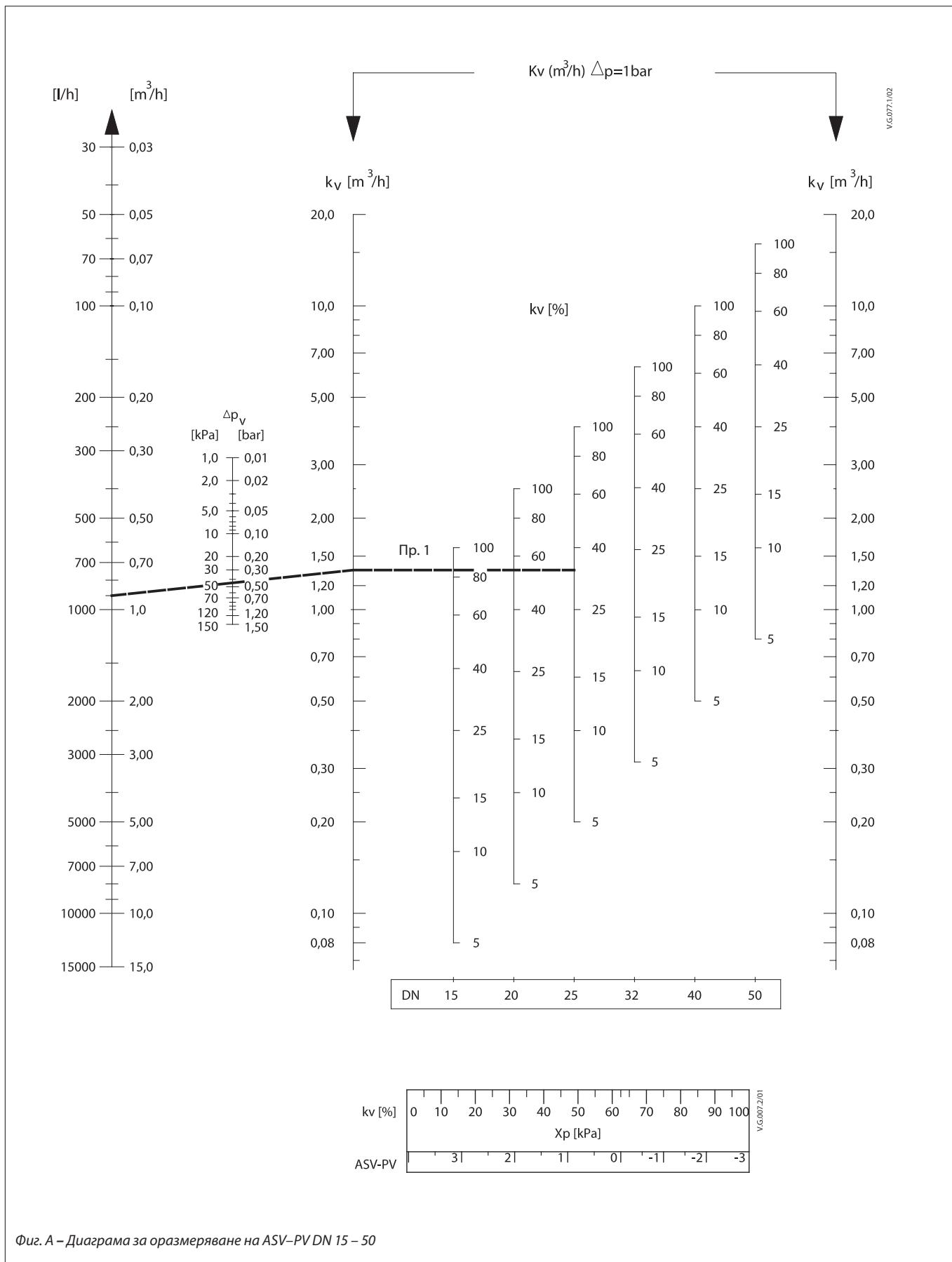
**Фиг. А – Диаграма за оразмеряване на ASV-PV DN 15 – 50**
