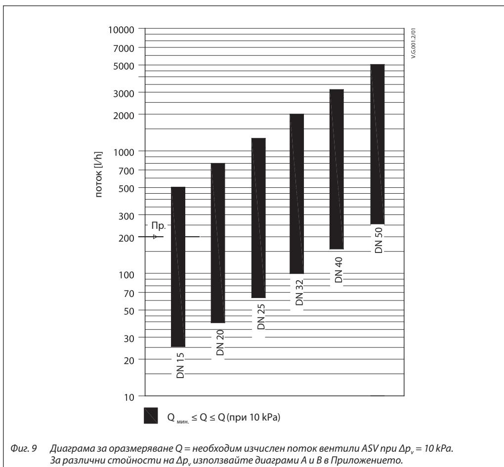
Препоръчваме вентилите ASV-PV да се оразмеряват, като се използва фиг. 9. Максималните стойности на потока са на база на 10 kPa диференциално налягане върху вентил ASV-PV, което позволява перфектно управляващо представяне на ASV-PV и пести енергия, докато минималният номинален поток позволява регулируемост близо до нулата.
