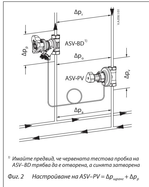
ASV-BD може да се използва извън или в управляемия контур, като се избере кой измервателен нипел да е отворен. Смяната на конфигурацията може да се направи под налягане – само чрез затваряне/отваряне на тестовите пробки.
