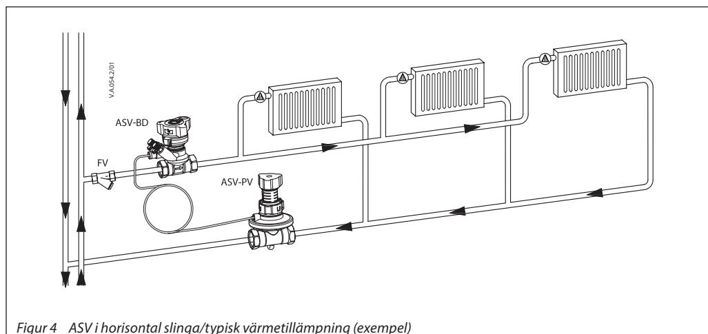
*Figur 4 ASV i horisontal slinga/typisk värmeförmedling (exempel)*
