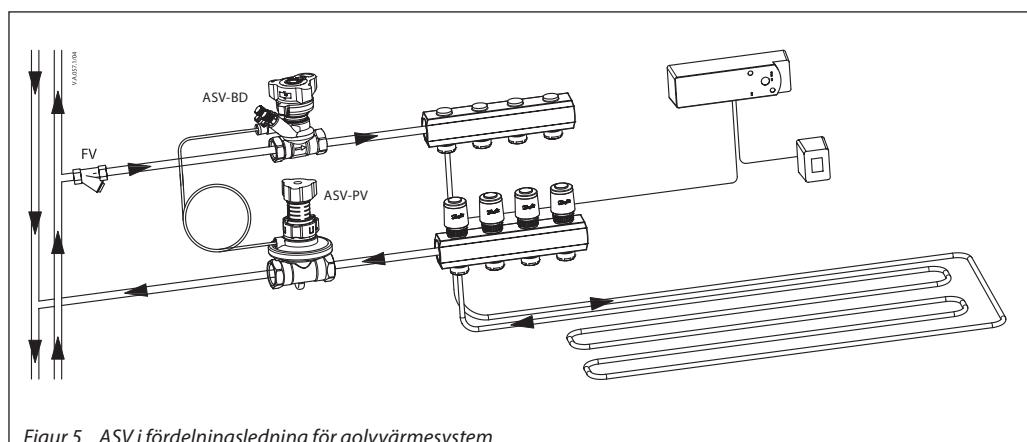
*Figur 5 ASV i fördelningsledning för golvvärme*
