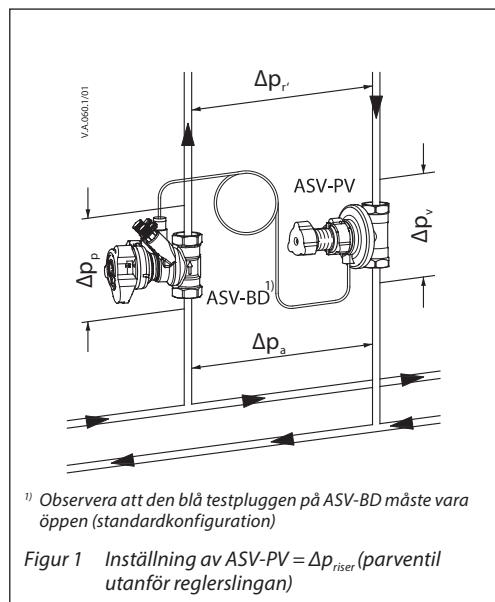
ASV-BD kan användas i den yttre eller inre reglerslingan genom att man väljer vilken mätspets som är öppen. Konfigurationen kan ändras under tryck – genom att testpluggarna stängs/öppnas.
