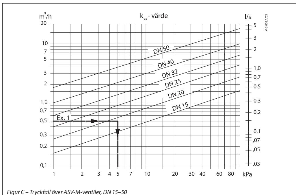
Figur C – Tryckfall över ASV-M-ventiler, DN 15–50
