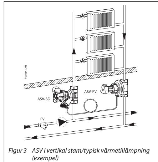
*Figur 3 ASV i vertikal stam/typisk värmeförmedling (exempel)*
