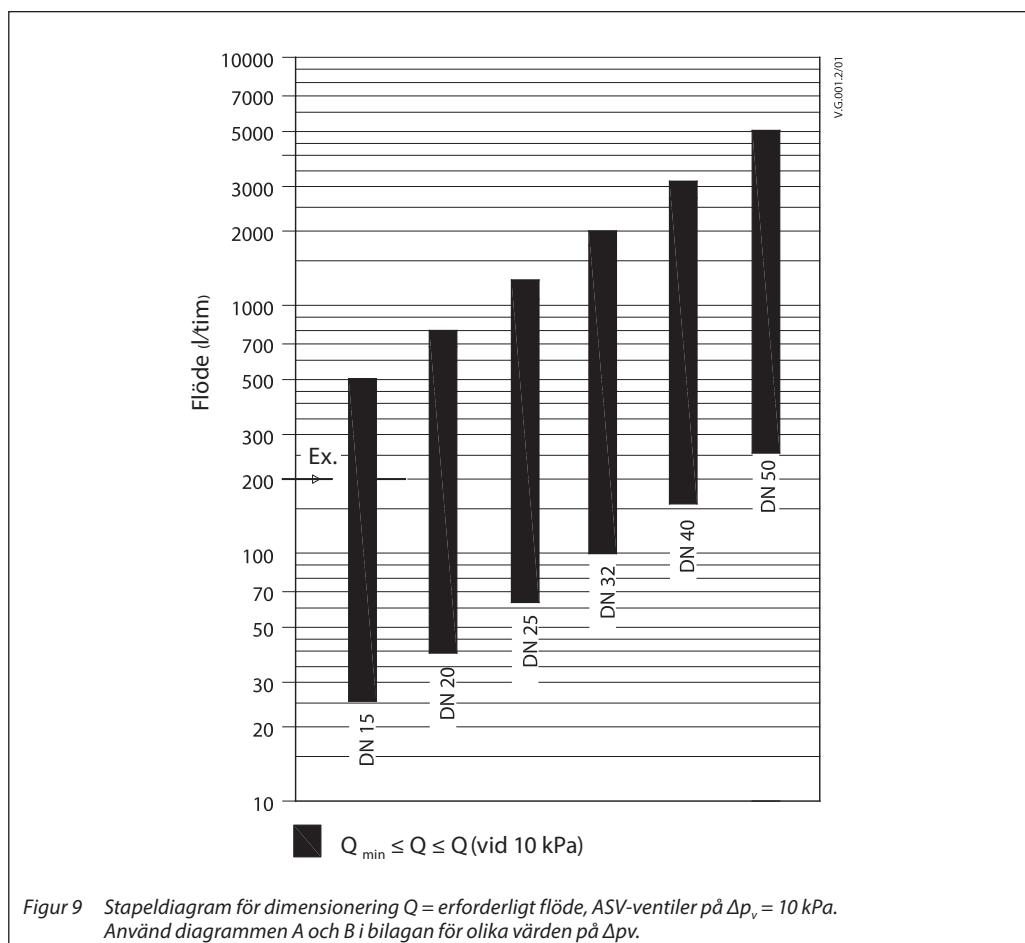
Vi rekommenderar att diametern på ASV-PV-ventilerna dimensioneras med hjälp av figur 9. Maximala flödeshastigheter baseras på 10 kPa differenstryck över ASV-PV-ventilen, vilket möjliggör perfekt reglering av ASV-PV och sparar energi, medan minimalt nominellt flöde tillåter reglering nära noll.
