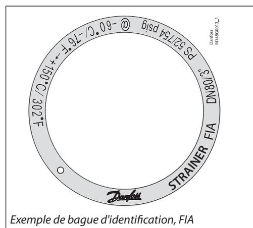
Exemple de bague d'identification, FIA
