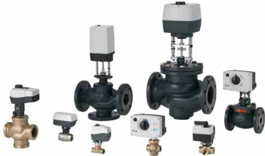
La gamma di valvole di regolazione motorizzate (MCV) per il teleriscaldamento possono essere utilizzate in impianti di riscaldamento o raffreddamento ad acqua o a glicole. Le MCV assicurano un controllo idronico stabile e preciso, con una migliore regolazione della temperatura e un conseguente maggiore comfort per l'utente finale. La gamma MCV comprende valvole standard e valvole con otturatori bilanciati in pressione per lavorare con elevate pressioni differenziali.
